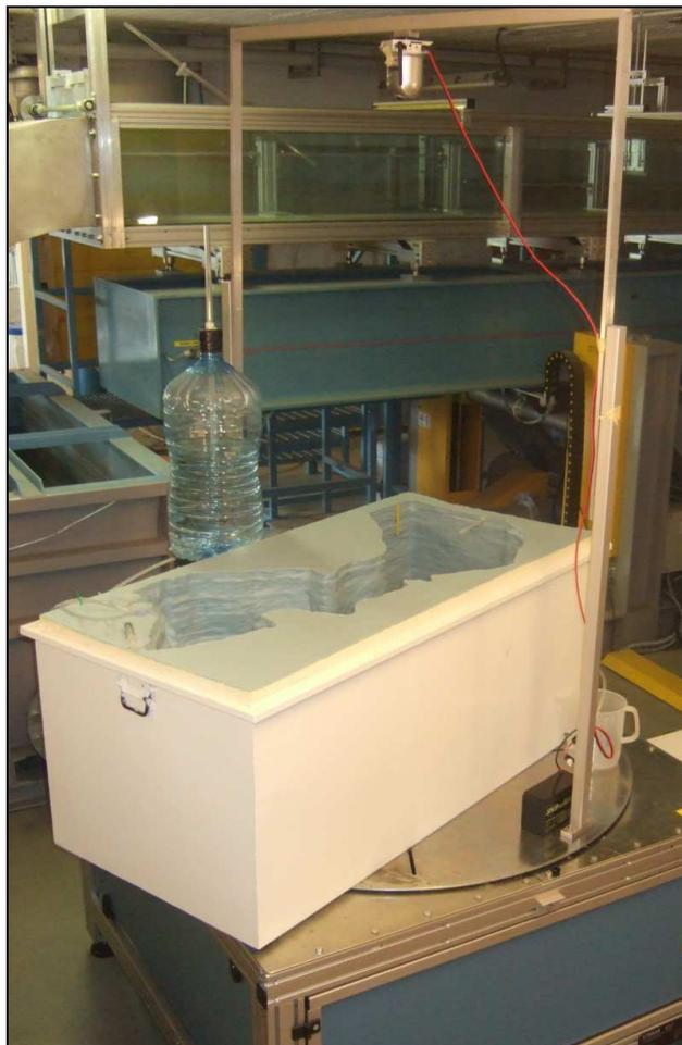
*Fotografia della tavola rotante con il modello fisico del Lago di Iseo a scala distorta*
