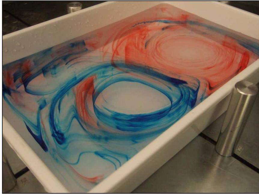
*Fotografia dell'esperimento delle colonne di Taylor, presa dall'esterno del sistema rotante.*
